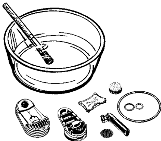
Ruční čištění rozložené chladicí jednotky
