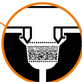
Částečně naplněná plnicí komora s kapalinovou vložkou.
