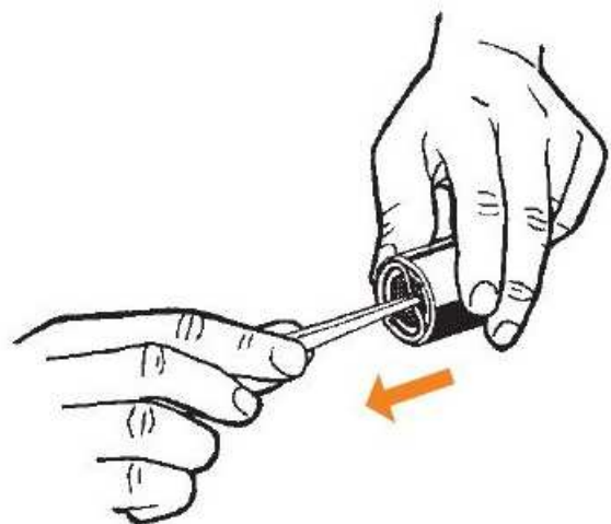
Vyjměte těsnící kroužek pinzetou
